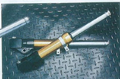
●キャリパーマウントと一体式の取り付けボトムケース。●分割が可能なのでメンテナンス性も◎。
